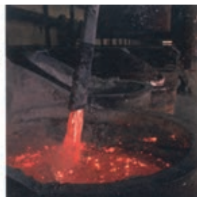
شکل ۱۸- فرایند هال برای تولید آلومینیم از \text{Al}_2\text{O}_3
