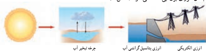
شکل ۹- انرژی پتانسیل گرانشی آب پشت سد توسط توربین‌ها و مبدل‌ها به انرژی الکتریکی تبدیل می‌شود.
