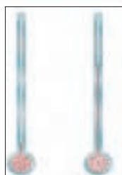
شکل ۳ - وقتی دما کم باشد، ارتفاع الکل یا جیوه در لوله کم است و با افزایش دما، ارتفاع الکل زیاد می شود.
