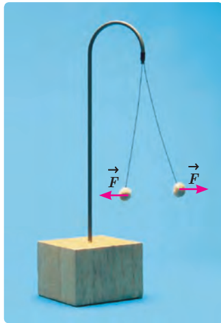
شکل ۴-۱ گوی های باردار همنام یکدیگر را با نیرویی هم اندازه دفع کرده اند.
