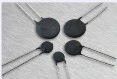
(ب) تصویری از چند ترمیستور دیسکی واقعی
