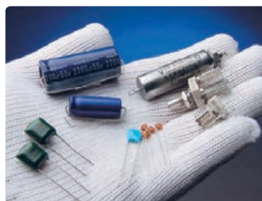
شکل ۱-۳۱ تصویری از چند خازن مختلف
