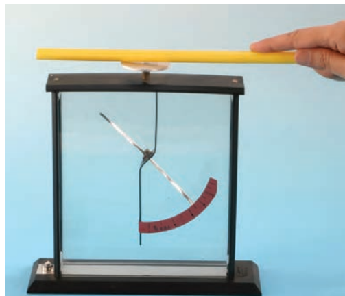
ب) جسمی باردار را به کلاهک الکتروسکوپ بدون بار نزدیک کرده یا تماس داده‌ایم.
