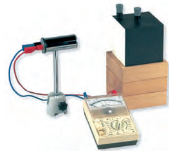
شکل ۴-۳۴ درون مکعب لسی، آب داغ می ریزند. تابش گرمایی از چهار وجه مکعب که رنگ های متفاوتی دارند، با هم فرق دارد.
