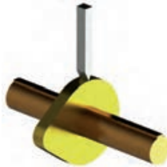
ب- ساز و کار حرکتی چرخ تسمه
