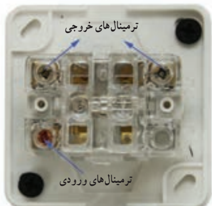
شکل ۱۴-۵- مدار داخلی کلید دو پل
