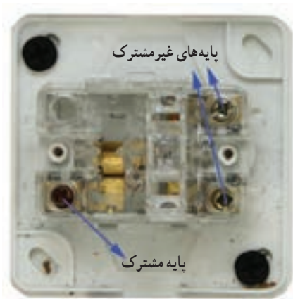
شکل ۱۹-۵- نمای داخلی یک نمونه کلید تبدیل
