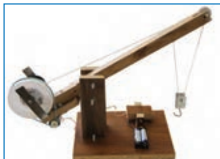
الف- ساز و کار حرکتی جرثقیل اسباب بازی
