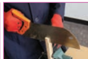
ث - اره کاری شیار بازوی چوبی
