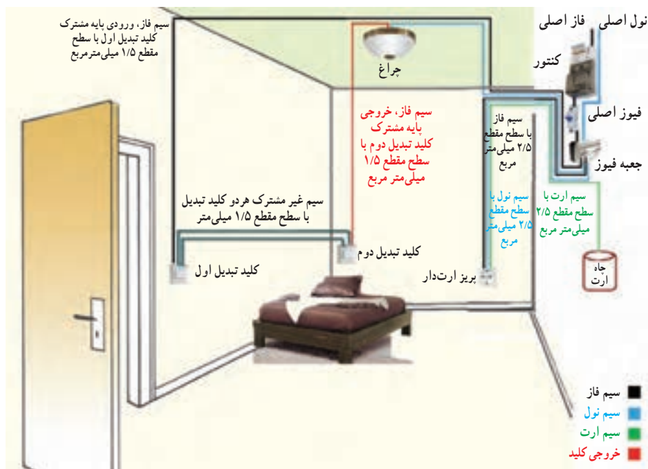
شکل ۱۸-۵ - سیم‌کشی مدار کلید تبدیل
